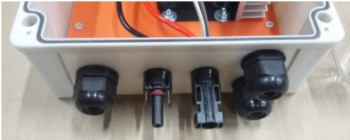
Figura 5: Conectores MC4 Fêmea (-) / Macho (+) do quadro com inversor de frequência FAMAC SOLAR.
