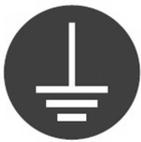
É obrigatório o aterramento das instalações elétricas conforme a regulamentação do país onde o equipamento será instalado. Na ausência desta, atender às normas internacionais vigentes do país onde estiver instalado.
