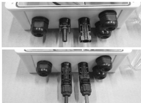
Conecte os conectores MC4 Fêmea (+) / Macho (-) vindos do arranjo de módulos fotovoltaicos aos conectores MC4 Fêmea (-) / Macho (+) do quadro com inversor de frequência FAMAC SOLAR.
